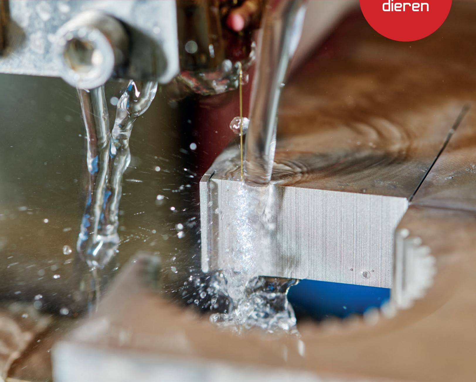
Modernste CAM-Technologie für die Drahterosion
